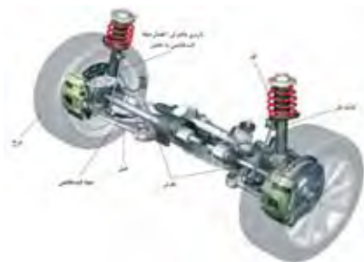
تصویر شماره ۲- سیستم تعلیق غیرفعال [۲]
