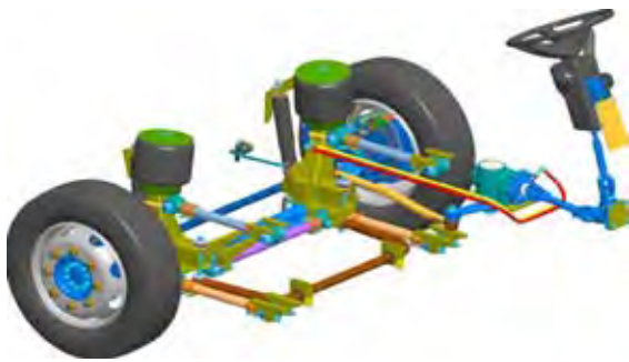
تصویر شماره ۴- سیستم تعلیق یکپارچه [۳]
