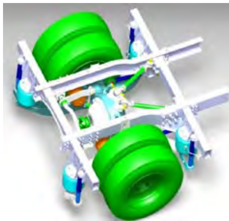
تصویر شماره ۷- سیستم تعلیق محور جلو شاسی دُرسا [۵]
