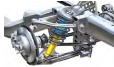
تصویر شماره ۵- سیستم تعلیق جناغی دوبل [۳]
